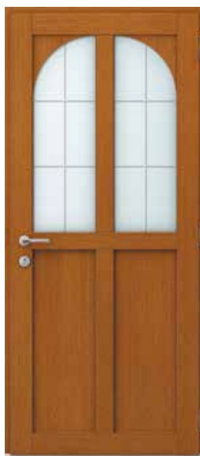
EXTÉRIEUR ALUMINIUM Couleur bleu 5023 S. Moulures rapportées. Double ou triple vitrage retardateur d'effraction dépoli. Option petit-bois plomb intégrés. INTÉRIEUR BOIS Finition chêne moyen. U_d \geq 1,5 \text{ W/m}^2.K // U_d \text{ triple vitrage} \geq 1,1 \text{ W/m}^2.K
